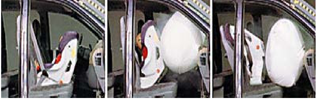
Şekil 22: Ön koltukta, arkaya dönük oturtulmuş infantın hava yastığının açılması durumundaki aldığı pozisyon.
