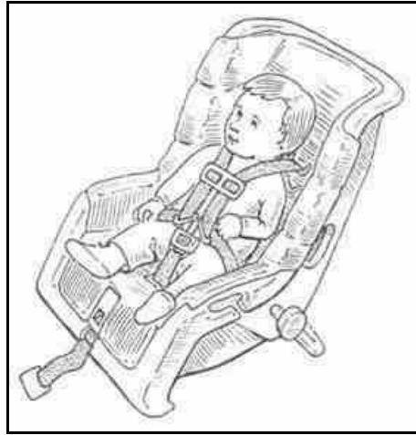
Şekil 5: Beş noktadan bağlı ÇOGK içinde çocuğun yerleşimi.
